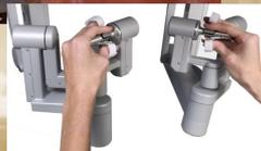
「ダビンチ」は術者の手の動きを、より細かく精密な動きに変換します。「ダビンチ」の鉗子は人の手関節以上の可動域で、鉗子の先端は人の指先に勝る緻密な動きが可能であり、安全・正確な手術を実現します。
