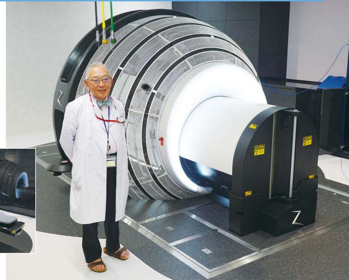
ZAP-X®ラジオサージェリーシステムと伊丹純センター長。ドームが遮蔽した状態(治療中の状態)で、長さは約5.7m、横幅約2.5m
